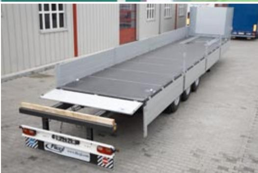
Полуприцеп для строительных материалов с кормовым выдвиганием и контейнерными замками
