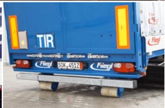
Или с защитными роликами для погрузки на пором.
