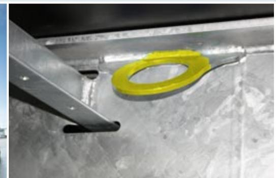
Стабильные петли обеспечивают надёжную фиксацию трейлера во время морской Перевозки.
