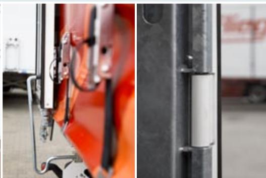
Задние порталные двери с двойными шарнирами вставляемые в угловые стойки- Для оптимальной защиты дверей в процессе загрузки по рампам. Двери находятся в открытом состоянии вплотную к боковому тенту. Так имеее Вы оптимальный Обзор при рамповом заезде и минимальному сопротивлению воздуха при езде с открытыми дверями.
