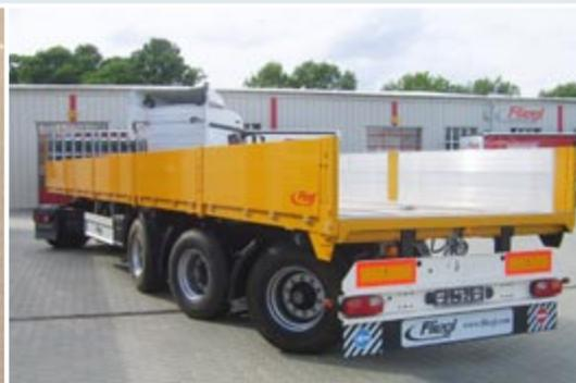
Также с двумя поворотными осями
