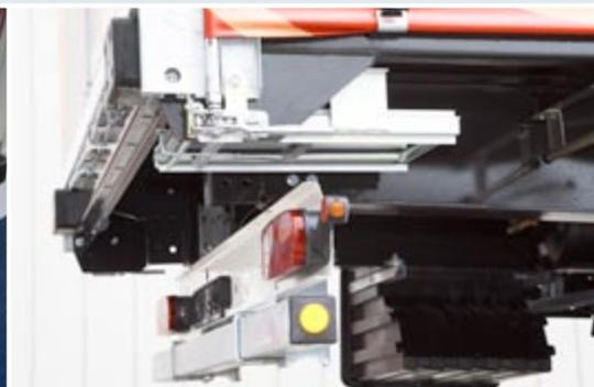
Нижняя защита и иллюминационная доска сконструированны по отдельности, хорошо защищены, уместны и тем самым в случае поломки удобно заменяемы. Кормовая часть серийно оборудована стабильными буферами.
