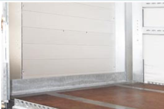
Массивная, фронтальная рамная рейка соединённая с шасси защищает фронтальную стену от повреждений погрузочными вилами погрузчика (опционально нагрузостойкие платы на болтовых соединениях)
