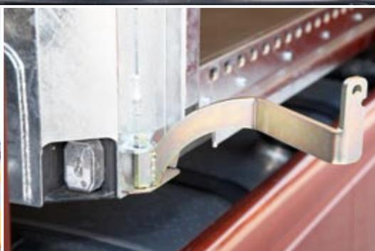
Рычаг ослабления натяжки тента со специально длинным рычажным ходом.
