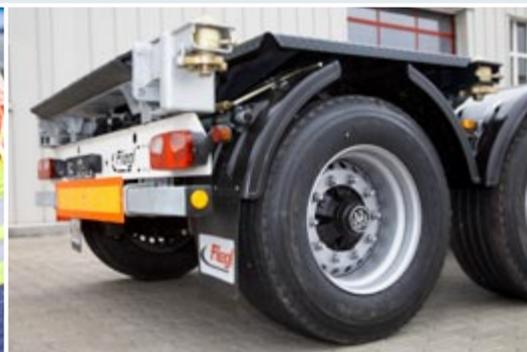
Стабильная поперечная защита рамы. Нижняя защита и осветительная доска выполнены как отдельные части хорошо защищены, уместны и в случае повреждения Легко заменяемы.
