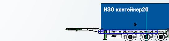
Варио-шасси В3 со сдвижением Контейнера для оптимального Распределения нагрузки.
