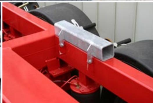
Стабильные ,откидываемо безопасные, утопляемые в рамы дополнительные «козлы»
