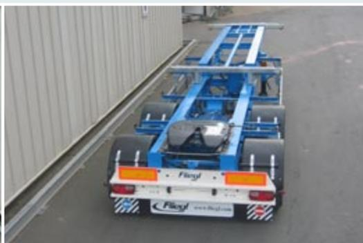
Комби-шасси для скандинавских стран 20 футовых впереди, легко перемещаем На зад. Загрузка и выгрузка и приём для следующего полуприцепа.
