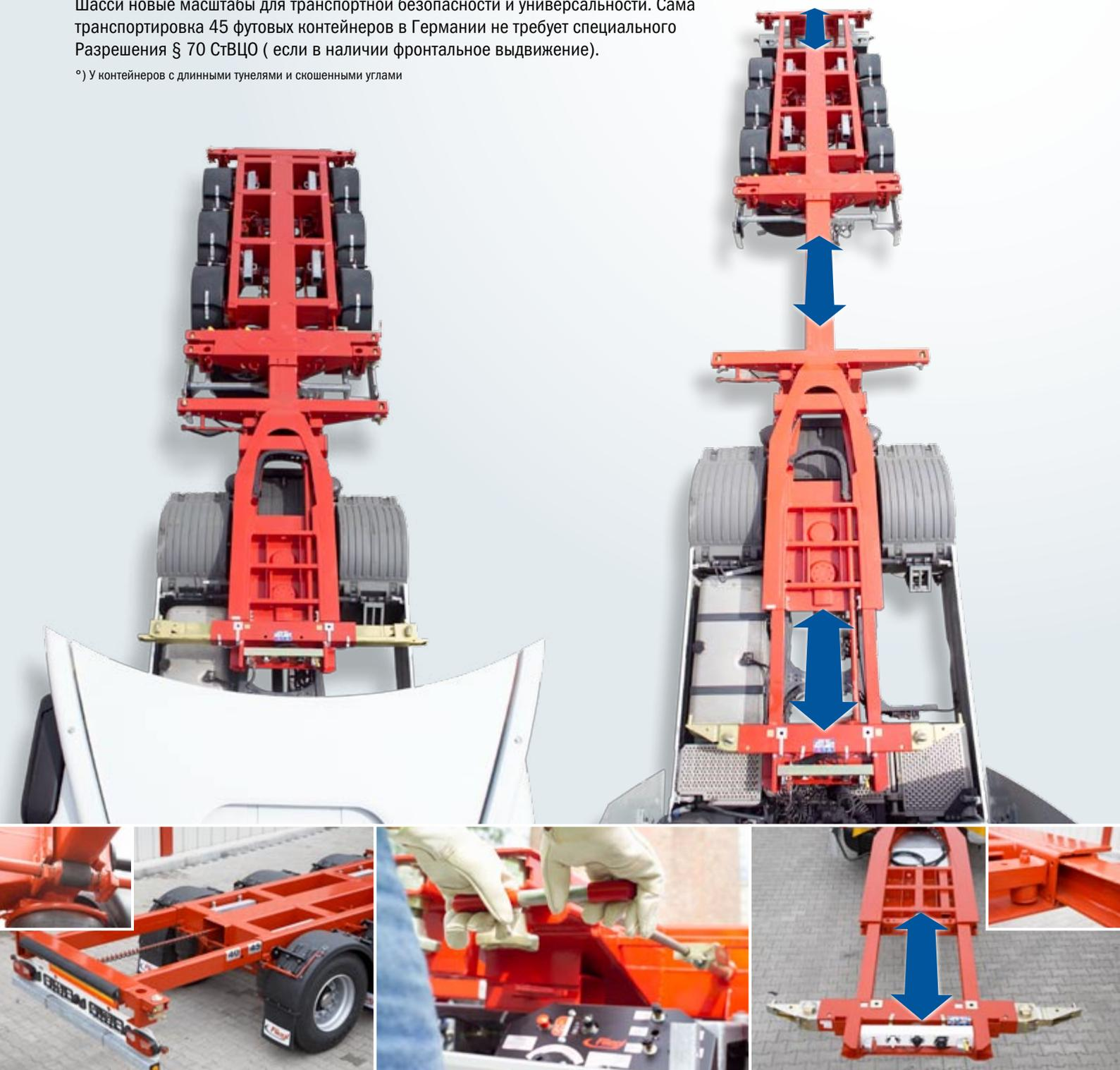
Ручное кормовое выдвигание (опционально пневматика) Выдвигание происходит на широких, износостойких роликах.
